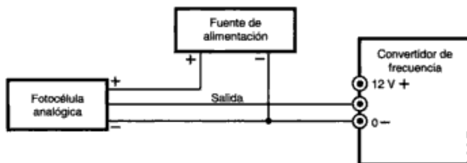
Figura 27. Conexión de una fotocélula analógica a un convertidor de frecuencia.
