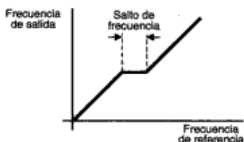
Figura 41. Salto de frecuencia para evitar la resonancia en la máquina.
