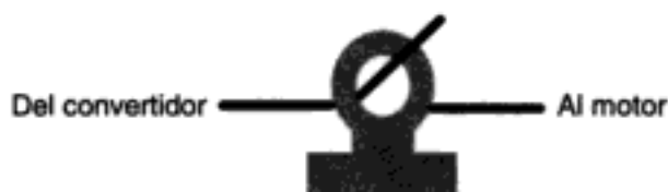
Figura 94. Instalación de ferrita de salida entre el convertidor y el motor.
